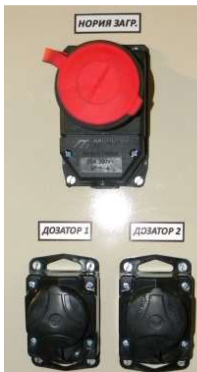
Рис. 2. Панель розеток На панели размешена 3-фазная розетка для подключения загрузочной норрии «НОРИЯ ЗАГР.»(по заказу) и розетки для подключения пультов управления баков препаратов «ДОЗАТОР 1» и «ДОЗАТОР 2»(по заказу)
