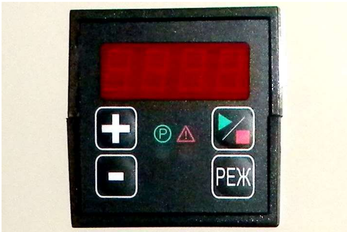
Рис. 7. Блок управления дозатором бака препарата
