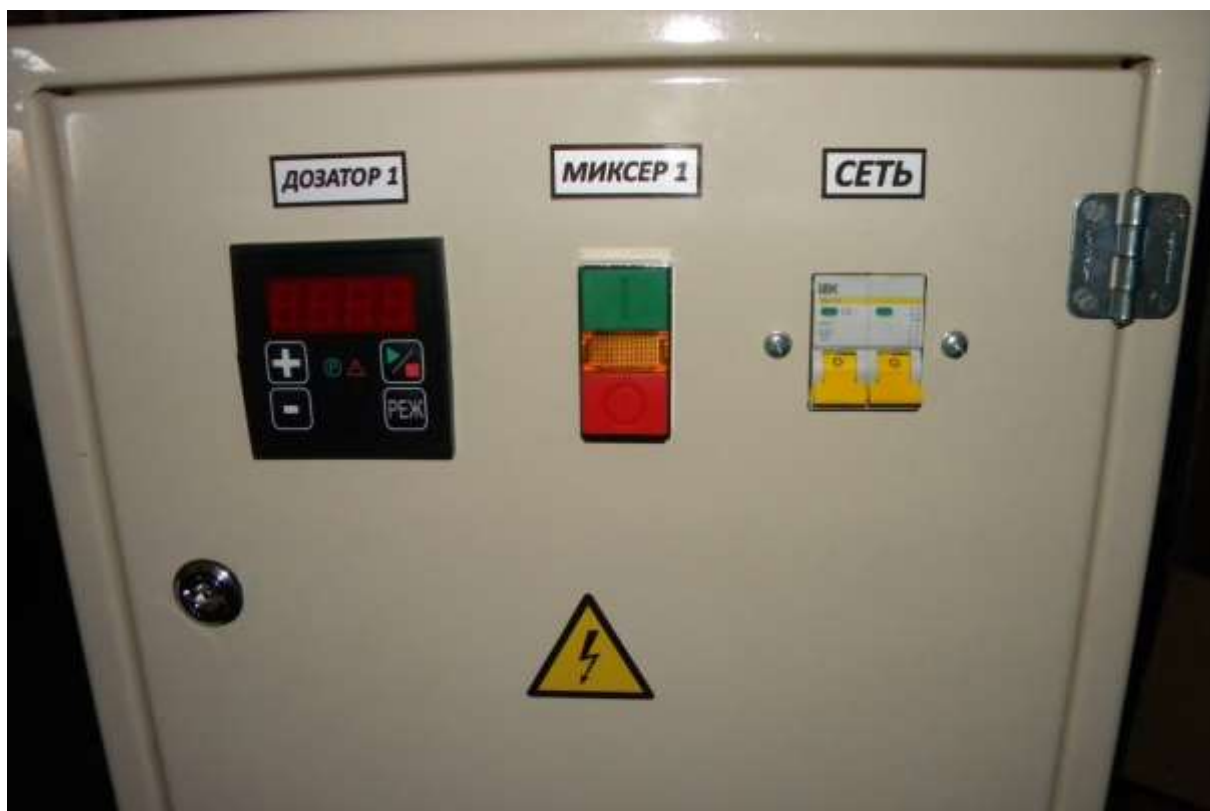
Рис. 5. Лицевая панель пульта управления бак-дозатора. На панели находятся: автоматический выключатель питания «СЕТЬ»; кнопка «ПУСК/СТОП» «МИКСЕР 1» и блок управления «ДОЗАТОР 1».
