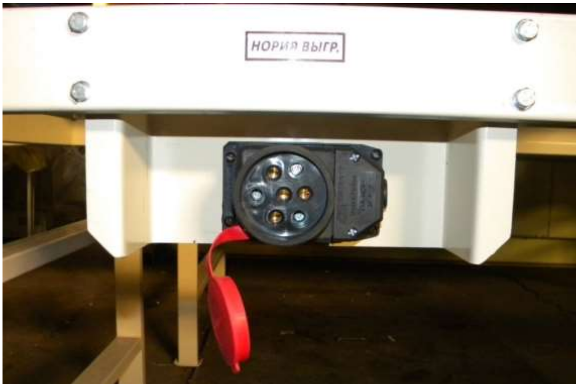
Рис. 3. Панель 3-фазной розетки выгрузной нории «НОРИЯ ВЫГР.» (по заказу)
