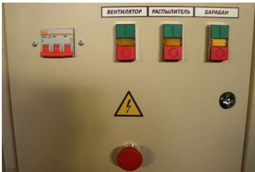
Рис. 1. Лицевая панель пульта управления протравливателя На панели находятся: автоматический выключатель питания, индикаторная лампа питания, кнопки «ПУСК/СТОП»: «ВЕНТИЛЯТОР», «РАСПЫЛИТЕЛЬ» и «БАРАБАН» и кнопка-грибок «СТОП» с фиксацией.
